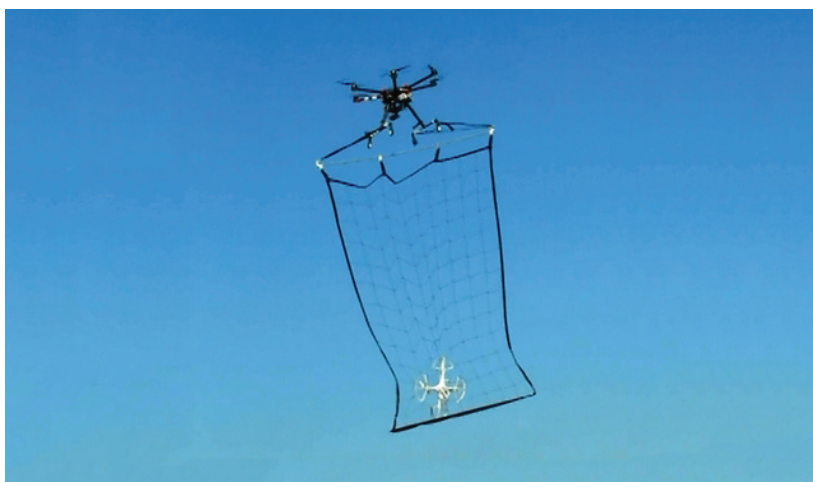
Рис. 7.2. Использование БПЛА-перехватчиков оборудованных сетью [279]
