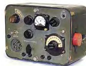
Справа: приемопередатчик «Севербис». На рисунке красный цилиндр справа — сменный кварцевый резонатор.
