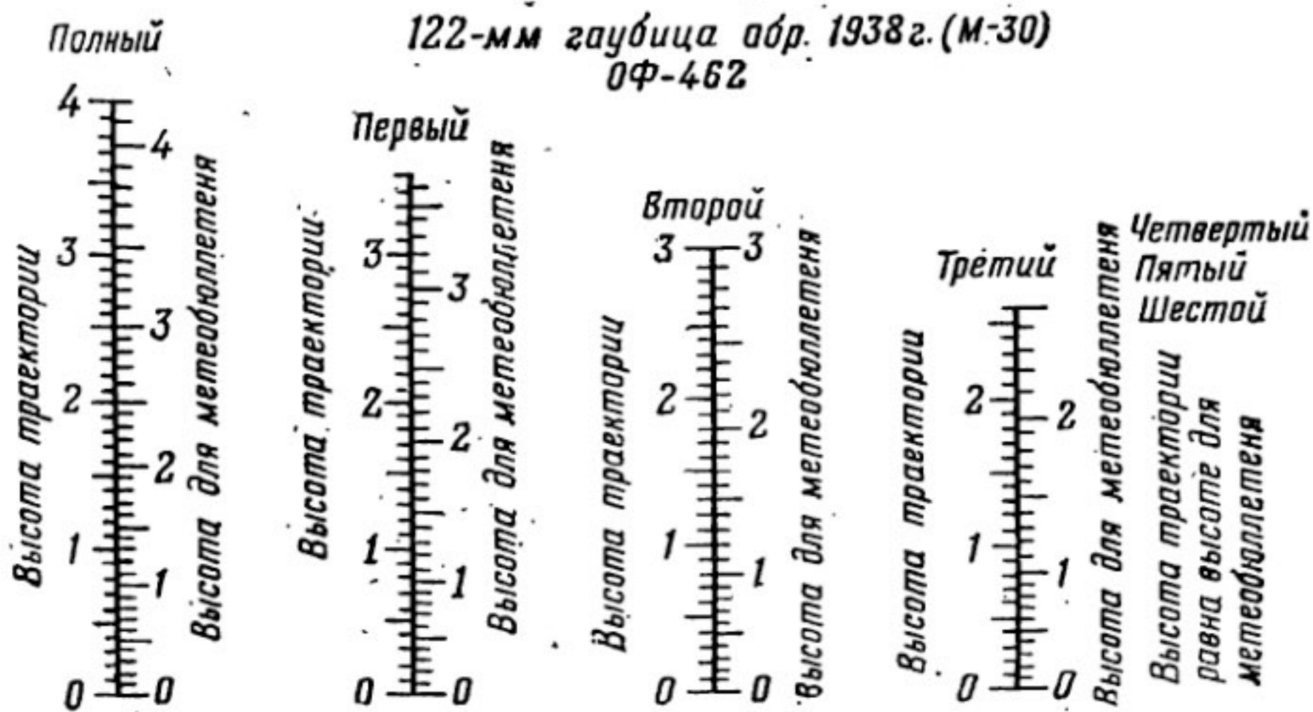
Рис. 3.3. Номограмма для определения высоты входа в бюллетень 122-мм гаубицы М-30
