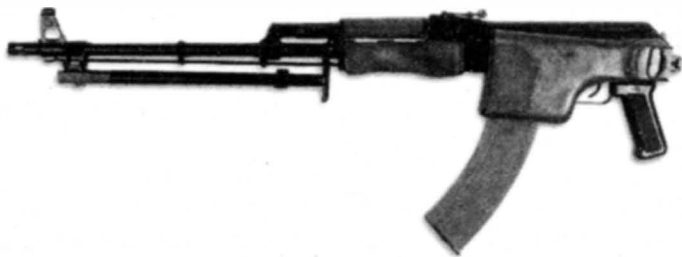
5,45-мм пулемет РPKC-74 со сложенным прикладом
