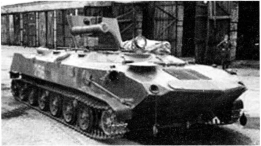
Десантный бронетранспортер БТР-РД «Робот» с ПТУР «Конкурс»
