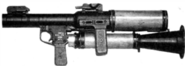
Ручной противотанковый гранатомет десантный РПГ-7Д в положении для десантирования
