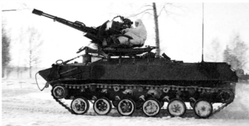
Бронетранспортер БТР-ЗД «Скрежет» с зенитным расчетом ЗУ-23
