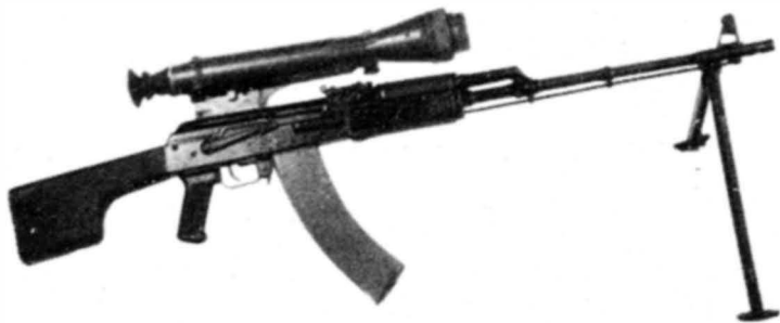
5,45-мм пулемет РПК-74Н с ночным прицелом НСПУ
