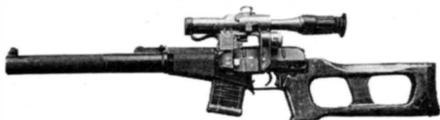
9-мм винтовка ВСС «Винторез» с оптическим прицелом ПСО-1
