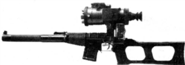
9-мм винтовка ВСС «Винторез» с ночным прицелом НСПУ-3
