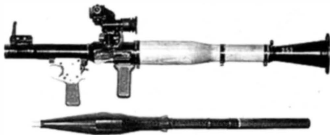
Ручной противотанковый гранатомет РПГ-7 и выстрел ПГ-7В
