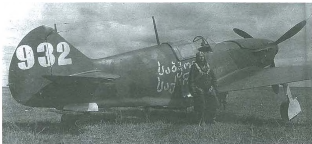
Истребитель ЛаГГ-3, созданный конструкторским коллективом (С.А. Лавочкин, В.П. Горбунов, М.И. Гудков). В частях ВВС с 1941г. Имел мощное вооружение: 23мм пушку, 2 крупнокалиберных пулемета и 2 пулемета калибра 7,62 мм
