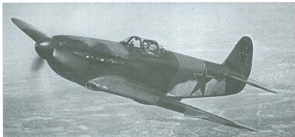
Истребитель Як-3 начал поступать в ВВС с 1943 г. Скорость – 651 км/час, потолок – 11800 м. Имел на борту связную радиостанцию, оборудование для ночных полетов
