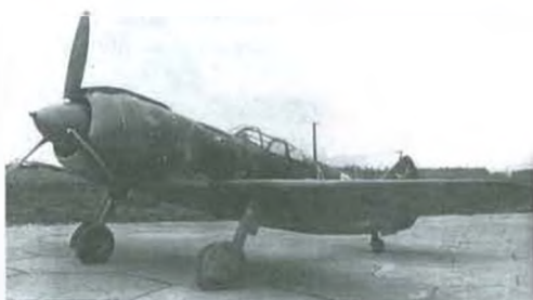
С 1942 г. вместо ЛаГГ-3 в ВВС стал поступать истребитель конструкции С.А. Лавочкина – Ла-5. Его скорость достигала 613 км/час, потолок – 11000 м. Вооружение – 2 x 20мм пушки
