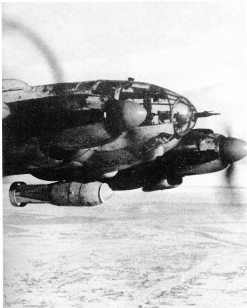
Бомбардировщик He-111Н с подвешенной под фюзеляжем бомбой типа «SC 1000». Тяжелые бомбы, которые вначале помещались внутри фюзеляжа, нередко заклинивало при сбрасывании, что в конечном счете вело к гибели самолета. Поэтому их стали подвешивать под фюзеляжем машины
