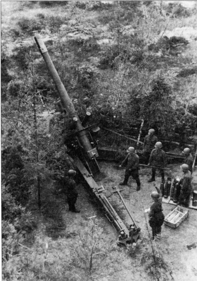
Очевидно, фотограф, сделавший этот снимок, не боялся высоты. Тяжелое орудие, изображенное на снимке, представляет собой 152-мм гаубицу-пушку МЛ-20 образца 1937 года, стволу которой придан практически предельный угол возвышения. Сталин называл артиллерию «богом войны»
