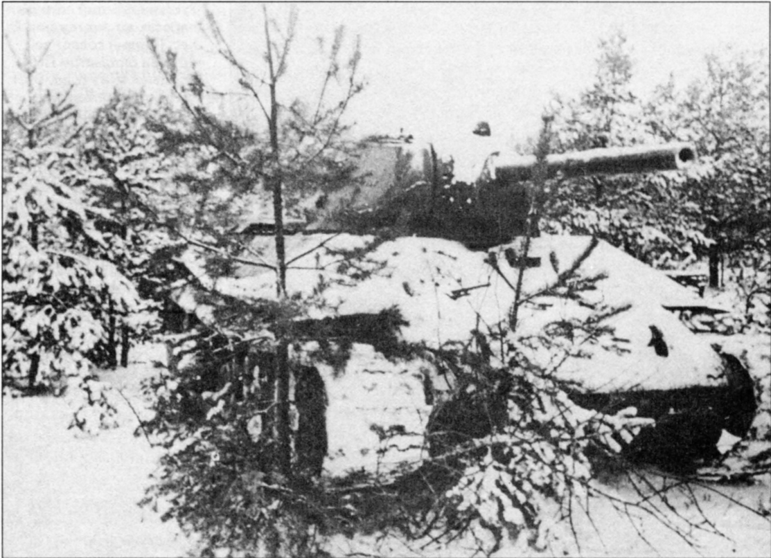
▲ Танк Т-34/76, главный танк советских танковых армий в середине войны, осторожно продвигается вперед. Наклонная броня (45 мм) позволяла уменьшить эффект попаданий снарядов немецких противотанковых орудий
