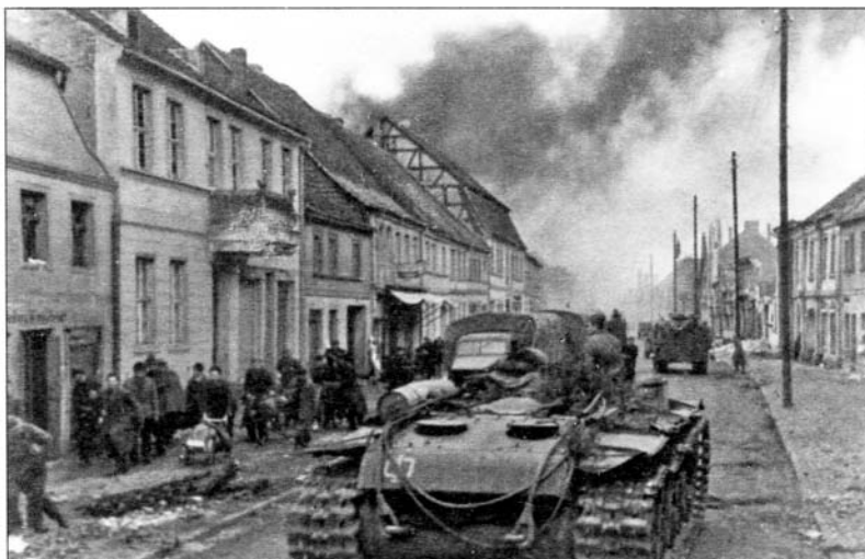
БРЭМ на базе старого танка КВ (с него демонтирована башня) в одном из городков на подступах к Берлину. 1-й Белорусский фронт, апрель 1945 года (РГАКФД)
