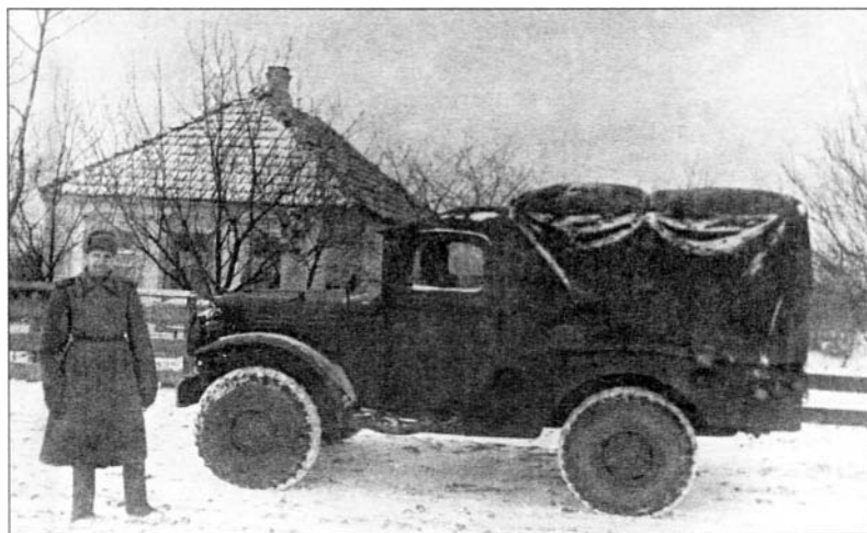
Легкий автомобиль американского производства «Додж» WC. Определение точной модификации модели затруднительно, так как дверь кабины, вероятно, уже приделана в ремонтных мастерских Красной Армии. 1-й Белорусский фронт, февраль 1945 года (АВЛ)
