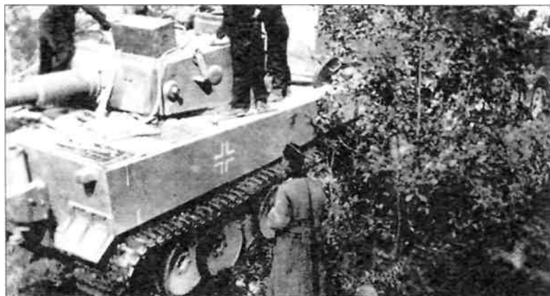
Эвакуация тяжелого танка «Тигр» после первого боя 29 августа 1942 года. У этой машины нет крепления для инструмента на кормовом листе корпуса, гранатометы на башне отсутствуют, хотя кронштейны для их установки уже есть. Группе армий «Север». 502й отдельный батальон тяжелых танков. август — сентябрь 1942 года (АВЛ)
