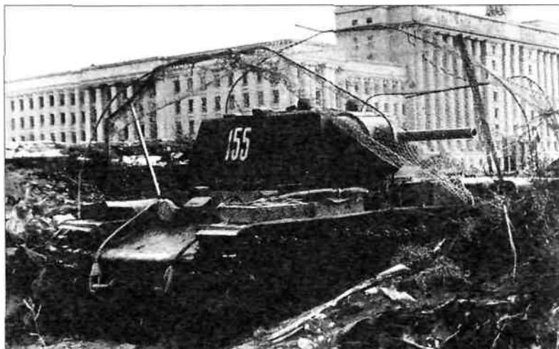
Тяжелый танк КВ-1 (упрощенной башней и усиленными катками) стоит в укрытии на Московском проспекте рядом с Дворцом Советов. В октябре 1941 года в этом районе Ленинграда в резерве командующего фронтом находилась 124 тбр (АВЛ)
