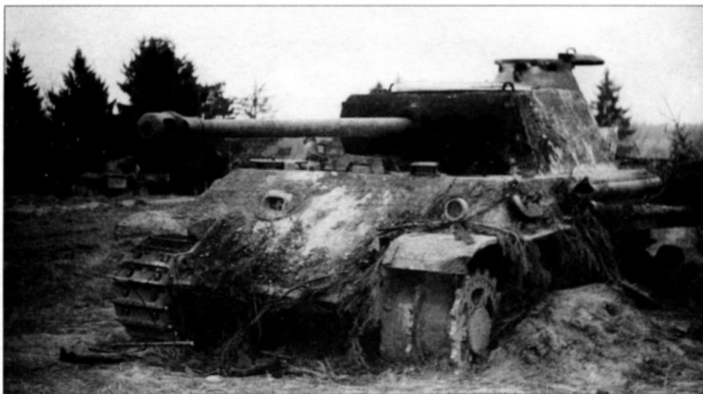
Немецкие танки Pz.Kpfw.V «Пантера» Ausf.G из состава 10-й немецкой танковой дивизии СС «Фрундсберг». Все машины покрыты антимагнитным покрытием циммерит. Группа армий «Висла», район Арнсвальде, середина февраля 1945 года.
