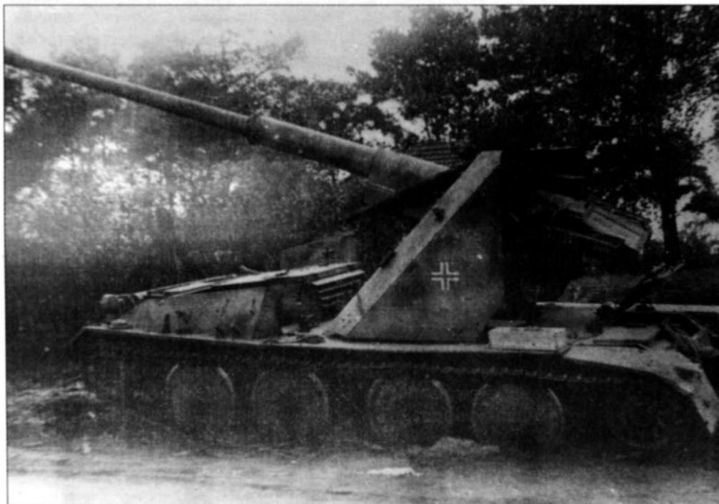
Новая 88-мм противотанковая САУ Waffentraeger конструкции доктора Ардельта, подбитый в боях на подступах к германской столице. Апрель 1945 года.
