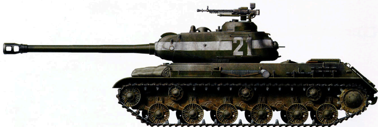
Тяжелый танк ИС-2 с тактическим номером «21». По периметру башни танка проведена взаимоопознавательная полоса, необходимая для городских боев в Берлине. Май 1945 года.
