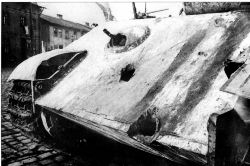
Видно, что «Пантера» получила две сквозных пробоины в переднюю часть корпуса. Познань, 19 тд вермахта, конец февраля 1945 года.
