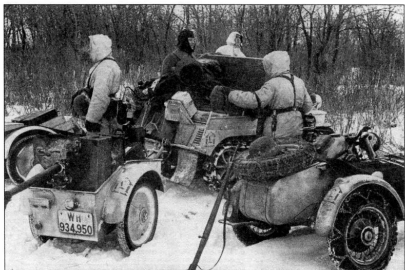
Смена позиции расчетом тяжелого 28-мм противотанкового снайперского оружия sPzB41. Оно установлено в прицеп к полугусеничному мотоциклу NSU. Рядом виден мотоцикл BMW 750 с коляской. Судя по тактическим обозначениям, танкоистребительное подразделение принадлежит одной из учебно-демонстрационных бригад вермахта. Группа армий «Б», январь 1943 года (АВЛ)
