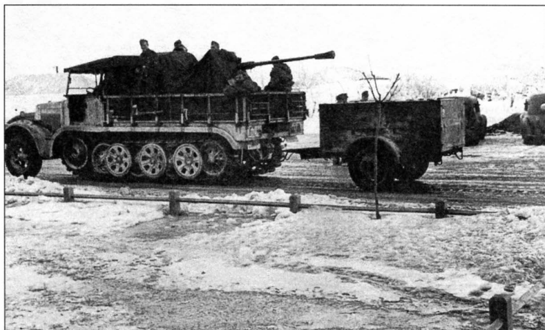
Зенитная установка Kfz.7/2 (37-мм пушка Flak 36 на полугусеничном тягаче Sd.Kfz.7) из 2-й панцергренадерской дивизии СС «Рейх». Группа армий «Юг», район Рогани, 14 марта 1943 года (РГАКФД)
