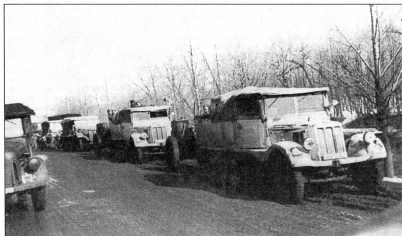
Колонна полугусеничных немецких тягачей Sd.Kfz.7 со 105-мм гаубицами sFH18 по дороге в район Чугуева. Группа армий «Юг», март 1942 года (АВЛ)
