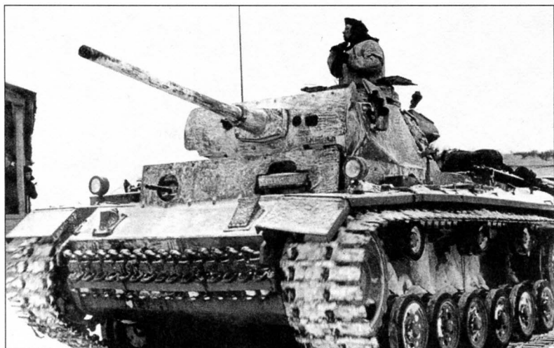
Средний танк Pz.Kpfw.III Ausf.L из 19-й танковой дивизии вермахта меняет позицию. Боевая машина оснащена расширенными «зимними» гусеницами, но запасные траки, закрепленные на переднем листе корпуса, обычные. Группа армий «Б», февраль 1943 года (АВЛ)
