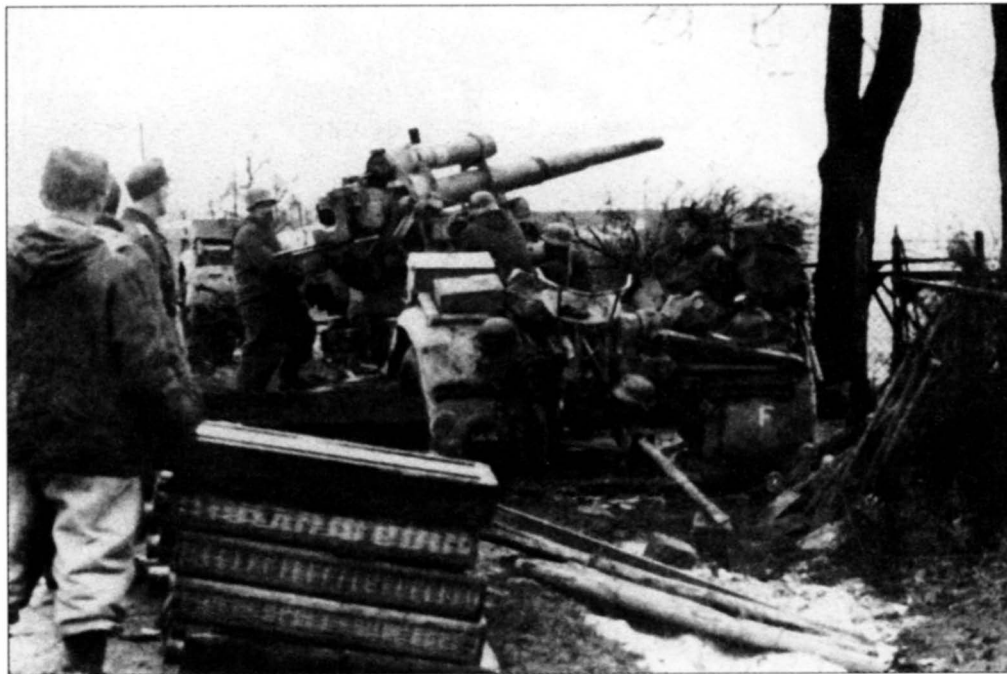
Позиция 88-мм орудия Flak 36/37, способного одинаково эффективно уничтожать как самолеты, так и танки противника. Силезия, город Бриг, февраль 1945 года.
