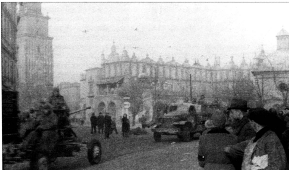
Моторизованная колонна зенитной артиллерии следует через улицы освобожденного Кракова. На переднем плане: 37-мм пушки 61-К образца 1939 года. Январь 1945 года.
