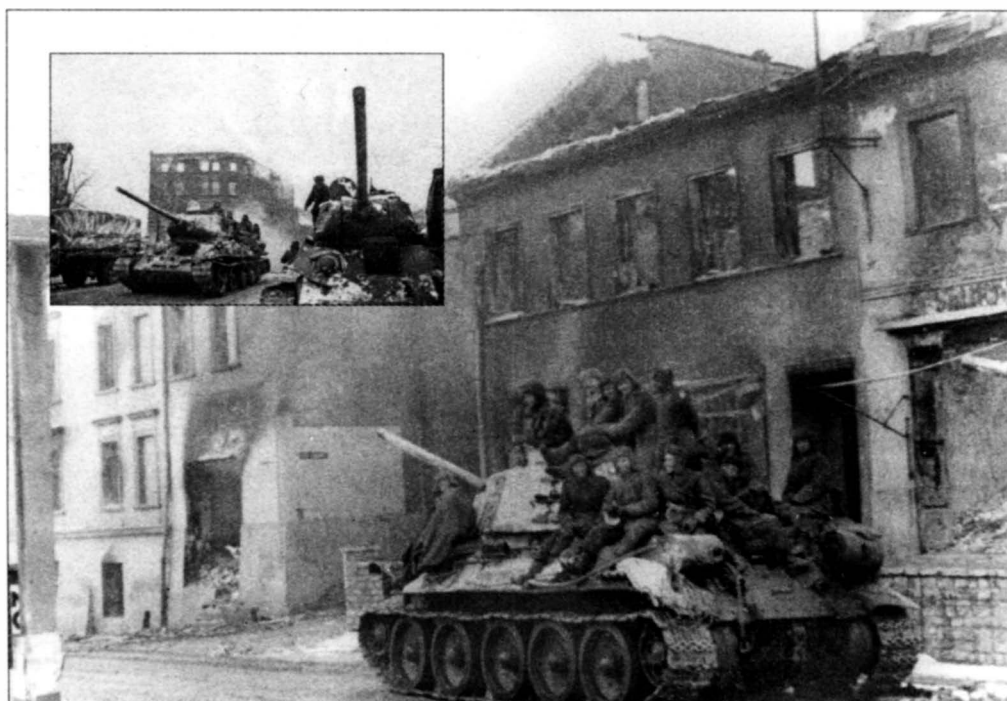
По буксирному устройству сзади и крепежу дополнительных топливных баков видно, что эта «тридцать четверка» была выпущена на заводе № 112 «Красное Сормово».
