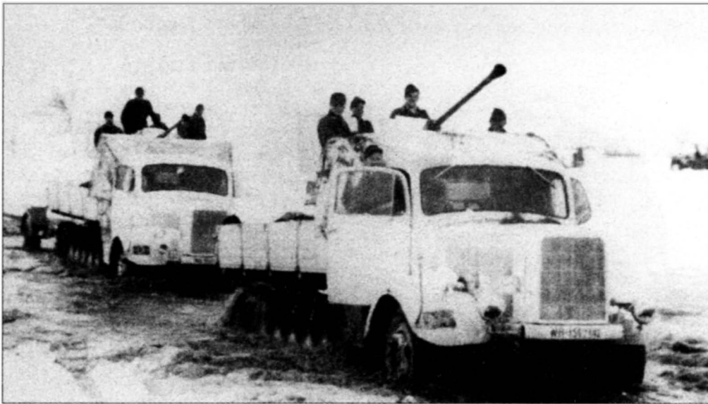
37-мм ЗСУ Flak 36, размещенные в кузовах 4,5-тонных полугусеничных грузовиков. Машины принадлежат 1-й лыжногерской дивизии. Январь 1945 года.
