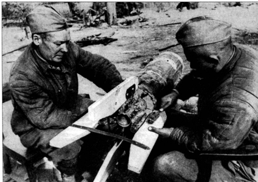
Последний этап работы — установка на «летающую торпеду» деревянного стабилизатора. Слева направо: красноармейцы-саперы К. Полуэктов и Н. Кондрашев. 1-й Украинский фронт, Бреслау, 62-я инженерная бригада, конец апреля 1945 года.
