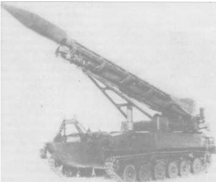
Самоходная пусковая установка тактической ракеты «Луна». На Кубе были на вооружении дивизионов МСП как с обычной, так и с ядерной головной частью
