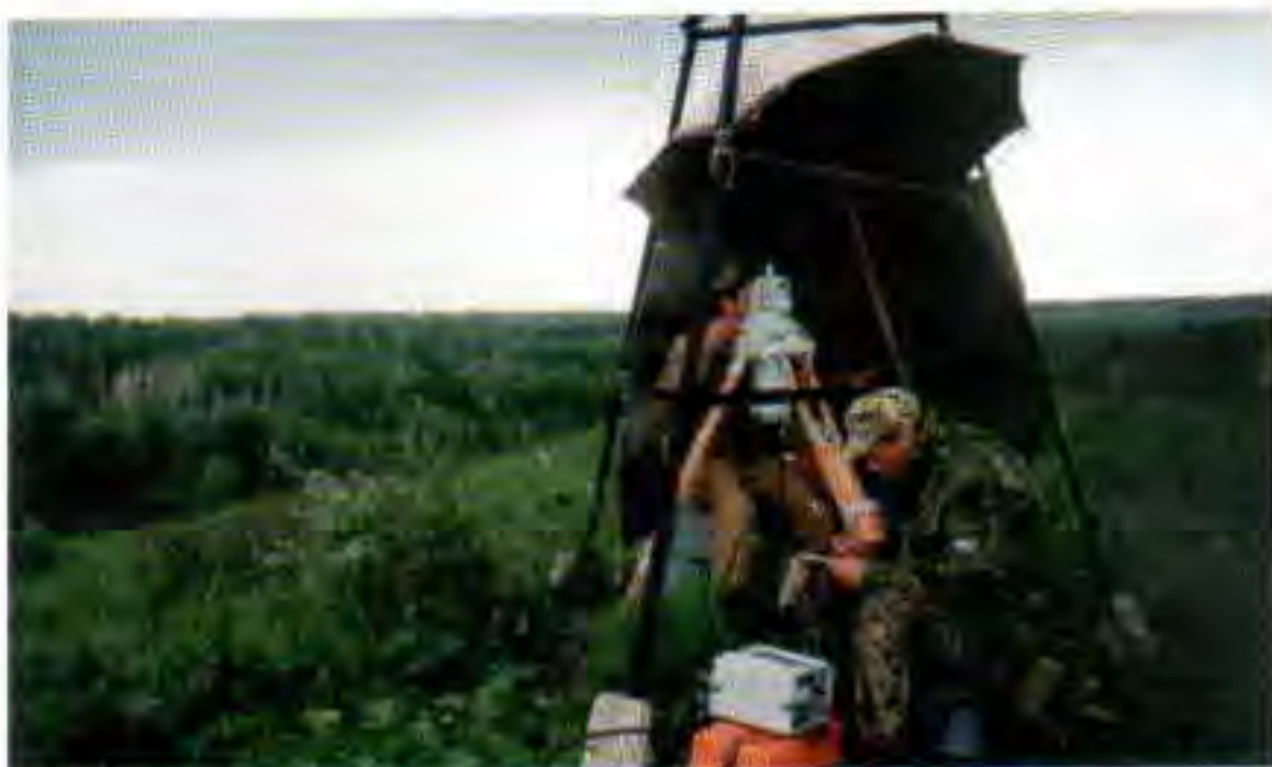
Определение азимутов гироскопическим способом. 1997 год
