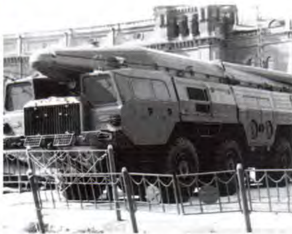
Самоходная пусковая установка 9П120 с изделием 9М76Б
