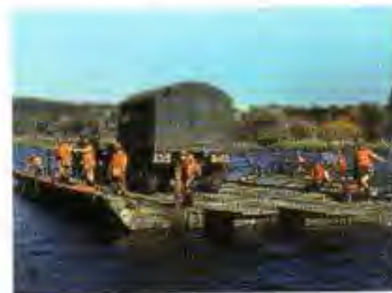
Подготовка понтонной переправы ракетного комплекса через реку Обь
