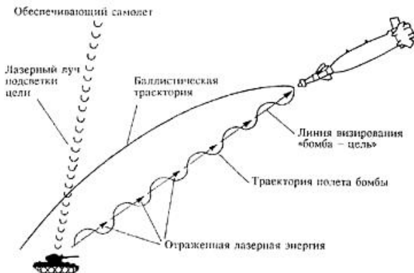
ФОТО 2.8. Принцип применения управляемой по лазерному лучу УАБ (управляемой авиационной бомбы)
