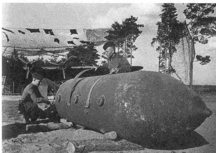
Советские летные оружейники готовят 5-тонную авиабомбу (ФАБ-5000) к подвеске на самолет-бомбардировщик Пе-8. Впервые такая бомба была сброшена ночью 28 апреля 1943 года на Кенигсберг
