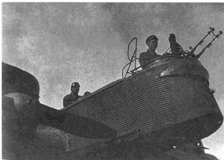
Многоцелевой самолет Р-6. Хорошо видна носовая турель Тур-6 с двумя пулеметами «Льюис». Дальний Восток, 1935 г.
