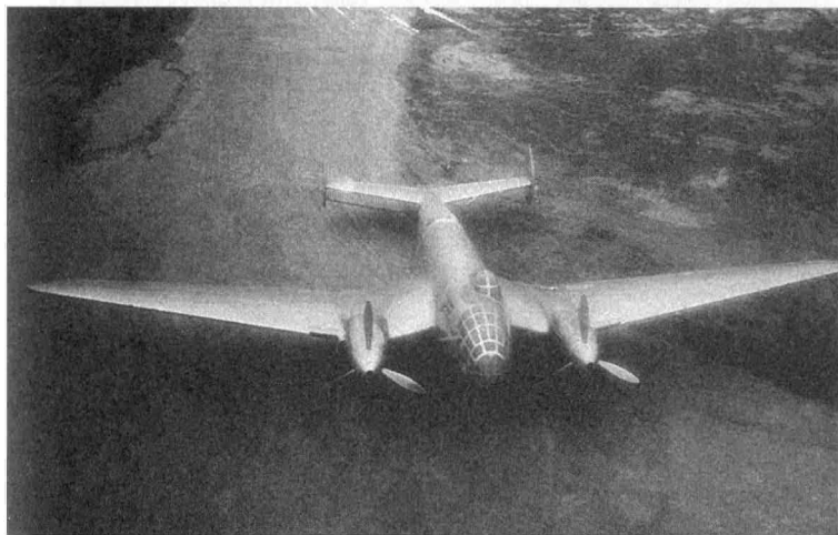
Дальний бомбардировщик Ер-2 на испытаниях в Летно-исследовательском институте (ЛИИ). На фото запечатлен первый прототип ДБ-240
