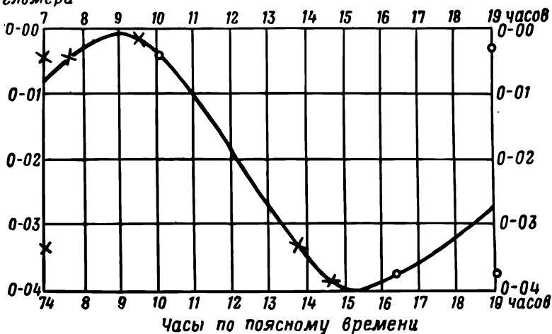
Рис. 48 График для определения суточного изменения поправки буссоли; все показанные на графике изменения поправок имеют знак плюс
