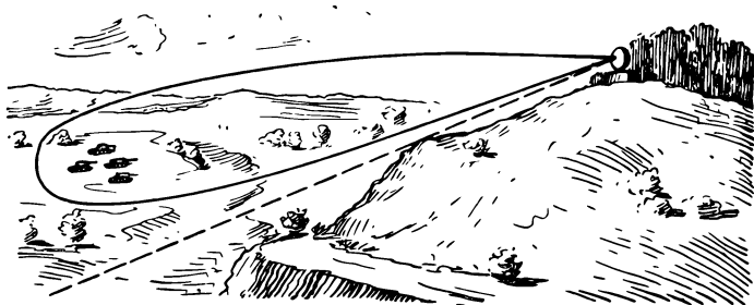
Рис. 12. Схема расположения на позиции радиолокационной станции, производящей разведку и засечку движущихся целей
