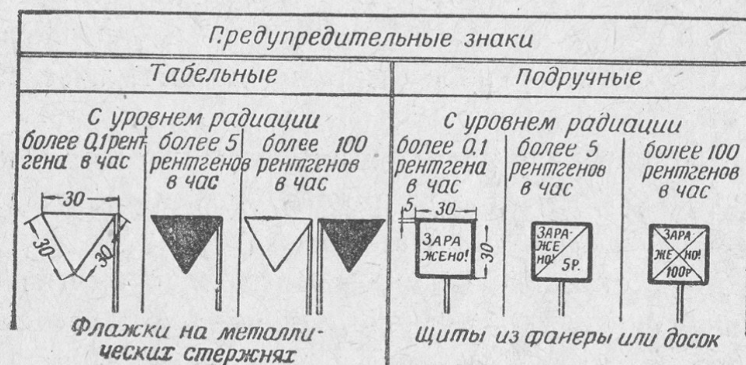
Рис. 11. Обозначение на местности предупредительными знаками границ участков, заражённых радиоактивными веществами
