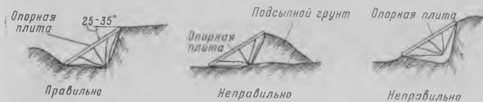
Рис. 34. Установка опорной плиты
