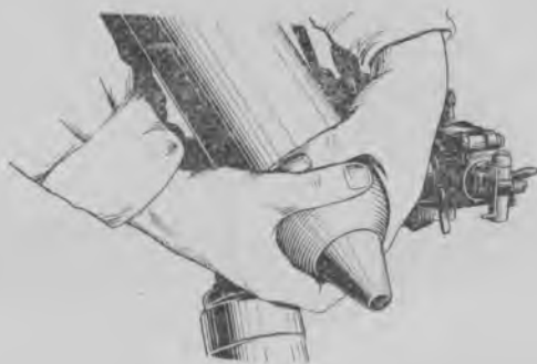
Рис. 42. Извлечение мины из канала ствола при разряжании миномета
