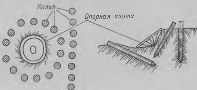
Рис. 36. Установка опорной плиты на грунте, укрепленном кольями, вбитыми наклонно
