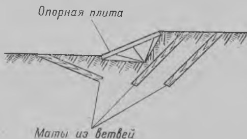
Рис. 37. Установка опорной плиты на грунте, укрепленном хворостом
