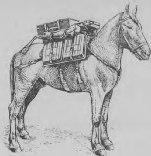
Рис. 62. Конский минометный вьюк № 2 с лотками для 82-мм мин, переносными вьюками лотков и ящиком с ЗИП
