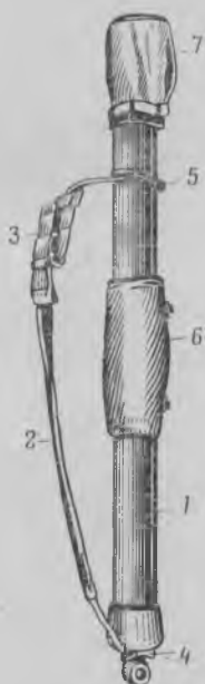
Рис. 29. Вьюк ствола: 1 — ствол с казенником и предохранителем от двойного заряжания; 2 — плечевой ремень; 3 — плечевая подушка; 4 — ремень казенника; 5 — хомут; 6 — подушка на ствол; 7 — дульный чехол
