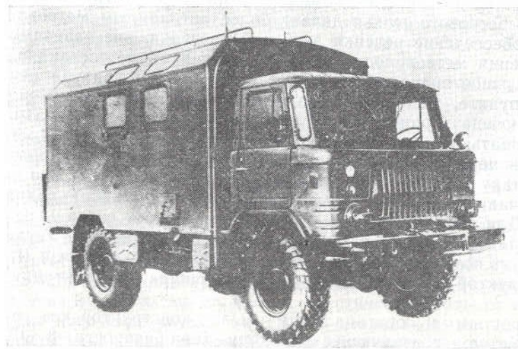
Рис. 28. Автомобиль ГАЗ-66, оборудованный под размещение аппаратуры центрального пункта
