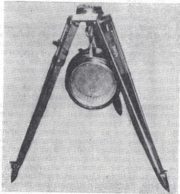
Рис. 1. Звукоприемник образца 1914 года, развернутый к работе
