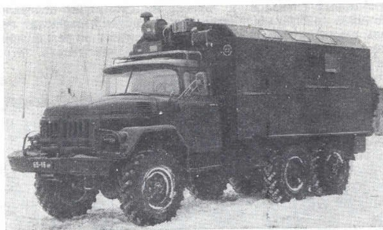
Рис. 31. Автомобиль ЗИЛ-131, оборудованный под размещение аппаратуры центрального пункта комплекса АЗК
