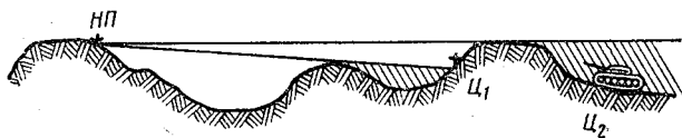
Рис. 20. Видимость цели с наблюдательного пункта при взаимном расположении укрытий различной высоты между наблюдательным пунктом и целью
