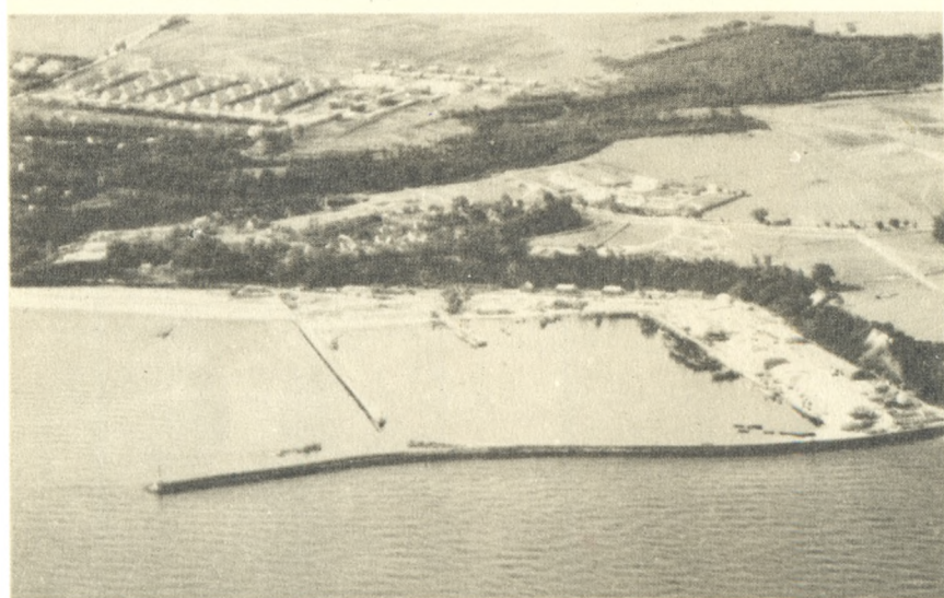
Фото 1 и 2. Плановый аэрофотоснимок масштаба 1:8 000 и перспективный аэрофотоснимок одной и той же местности: 1-мол; 2-пирс; 3-маяк; 4-буны
