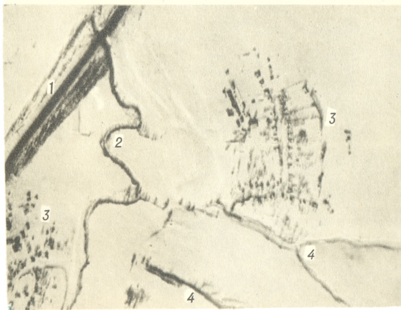
Фото 3 и 4. Летний аэрофотоснимок масштаба 1:11 000 и зимний аэрофотоснимок масштаба 1:15 000 одной и той же местности: 1-железная дорога; 2-ручей, поросший лесом и кустарником; 3-населенный пункт сельского типа; 4-овраг
