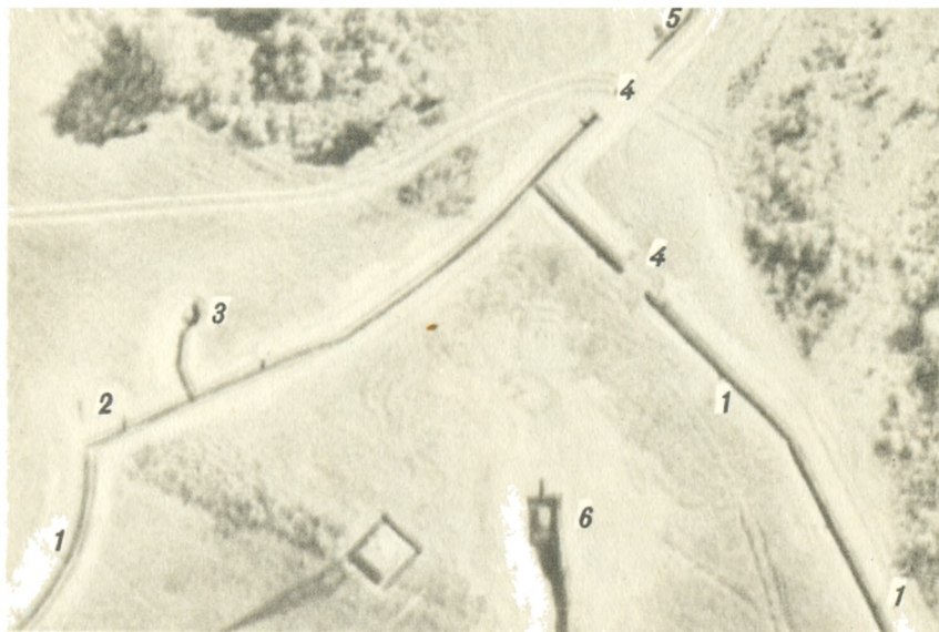
Фото 9. Фортификационные сооружения и боевая техника на аэрофотоснимке масштаба 1:1400: 1-стрелковая ячейка; 2-долговременное огневое сооружение; 3-пулеметная площадка; 4-перекрытый участок траншеи; 5-площадка для гранатомета; 6-танк в укрытии
