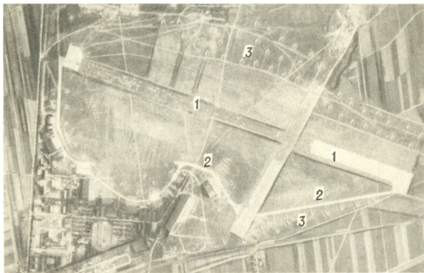
Фото 13. Аэродром на аэрофотоснимке масштаба 1:23 000: 1-взлетно-посадочная полоса; 2-рулежная дорожка; 3-укрытия для самолетов
