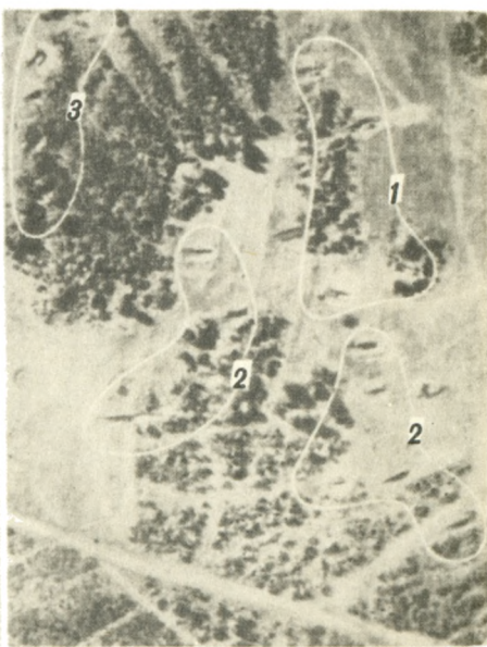
Фото 12. Укрытия для боевой и другой техники: а -автомобиль в укрытии; б -укрытия на аэрофотоснимке масштаба 1:1500; в -укрытия на аэрофотоснимке масштаба 1:5000; 1 -укрытия для танков; 2 -укрытия для автомобилей; 3 -укрытия для бронетранспортеров; 4 -выем для ствола пушки танка
