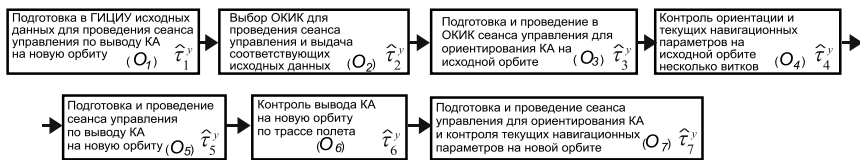
Рис. 5.9. Агрегированная операционно-временная модель действий органов управления при коррекции орбиты КА
