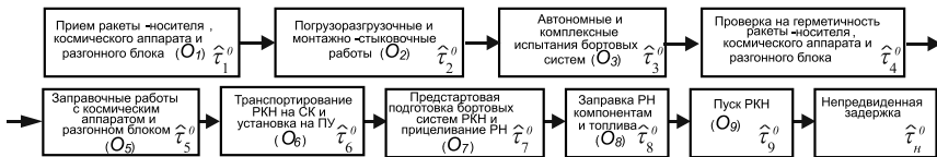
Рис. 5.8. Агрегированная операционно-временная модель действий боевых расчетов при запуске отдельного КА
