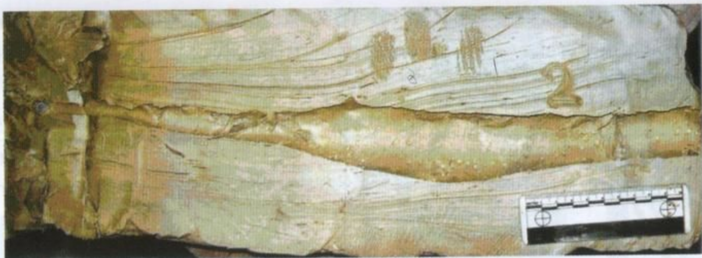
Рис. 3.3. Остаточная полость в пластилине от пули патрона 9x18 ПМ
