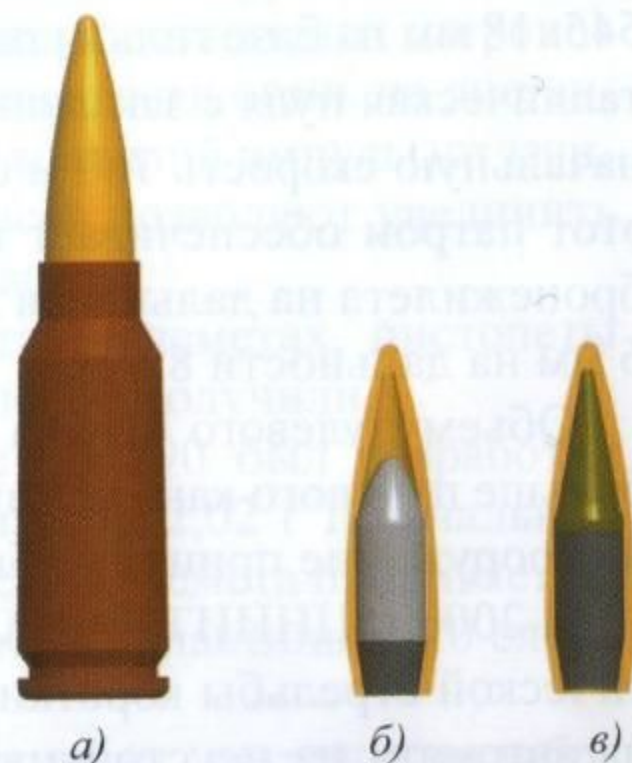
Рис. 1.9. Патрон 4,5x23 мм а) патрон 4,5x23 мм; б) пуля с бронебойным сердечником к патрону 4,5x23 мм; в) пуля со свинцовым сердечником к патрону 4,5x23 мм.
