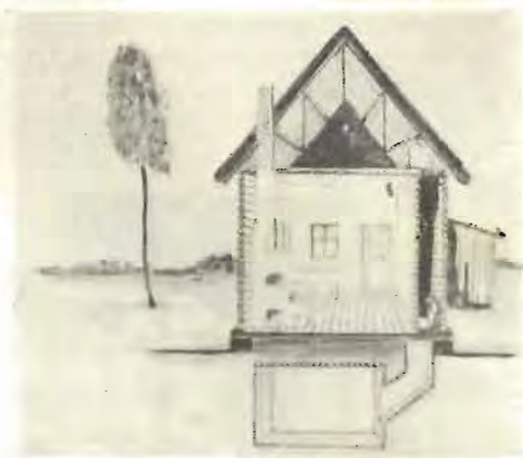
Рис. 10. Бандитский бункер в двойной стене дома бандпособника. Этот бункер потайным ходом соединен с другим бункером, устроенным под полом.
