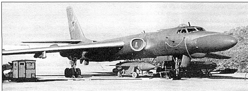
Самолет Ту-16 К с ракетой на транспортной тележке
