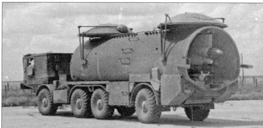
Транспортно-пусковая установка для беспилотного самолета-разведчика Ту-243
