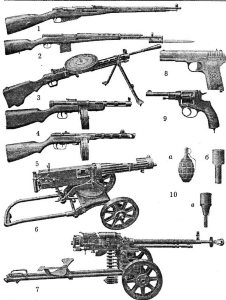
Рис. 1. Основные виды стрелкового оружия, находящегося на вооружении в частях войск ПриБОВО: 1 — винтовка Мосина; 2 — самозарядная винтовка (СВТ-40); 3 — ручной пулемет (ДП); 4 — пистолет-пулемет (ППД); 5 — пистолет-пулемет (ППШ); 6 — станковый пулемет «Максим»; 7 — 12,7-мм крупнокалиберный пулемет образца 1938 г. (ДШК); 8 — пистолет (ТТ); 9 — револьвер («Наган»); 10 — ручные гранаты: а — осколочная оборонительная (Ф-1); б — осколочная наступательная (РГД-33); в — противотанковая фугасного действия (РПГ-40).
