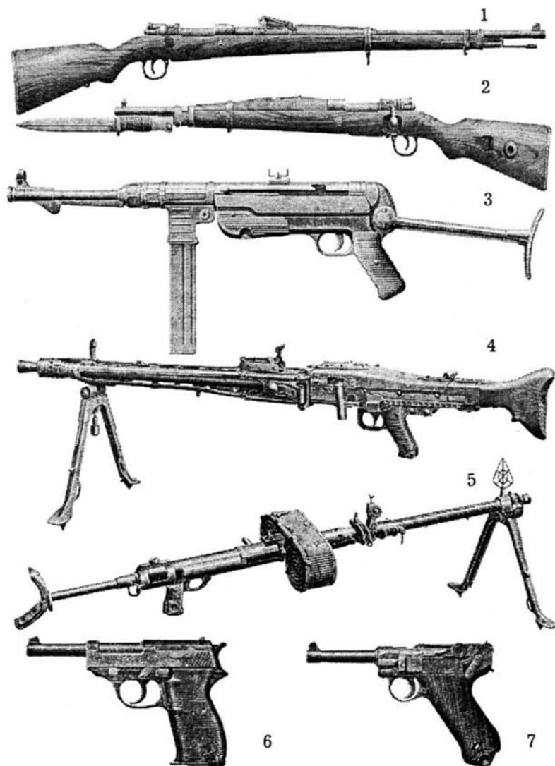
Рис. 9. Основные виды стрелкового вооружения пехотных частей вермахта на 22 июня 1941 года: 1 — винтовка системы Маузера обр. 1898 г.; 2 — карабин 98к; 3 — автомат MP-40; 4 — единый пулемет MG-34; 5 — ручной пулемет MG-08/18; 6 — пистолет системы Вальтер (P-38); 7 — пистолет системы Парабеллум (P-08).
