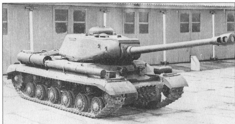
Тяжелый танк ИС-2М, модернизированный в 1954 г.
