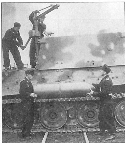
Загрузка боеприпасов в «Штурмтигр»: подъем снаряда при помощи крана-лебедки
