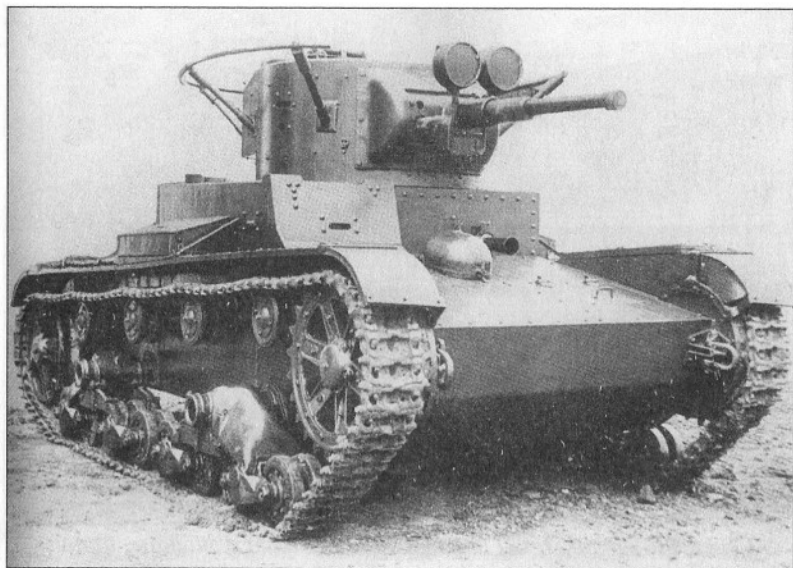
Легкий танк Т-26 с цилиндрической башней, рацией и фарами ночного боя
