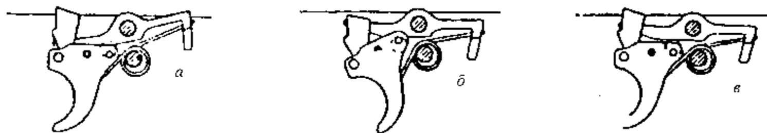
14.16. Положение деталей спускового механизма: а — в положении готовности к стрельбе; б — во время ведения огня; в — при постановке на предохранитель
