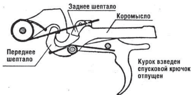
Спусковой механизм винтовки ЗН-29
