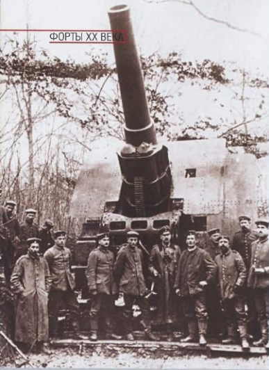
«Убийца» крепостей – немецкая мортира калибра 305 мм, выпускавшаяся на заводах Круппа под индексом L/16
