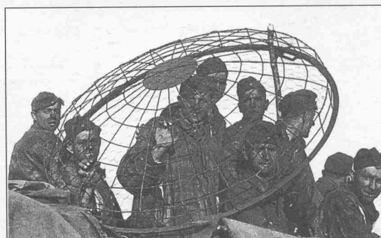
Транспортер боеприпасов, переделанный из PzKpfw III Ausf J, один из трех, входивших в состав 653-го батальона. Решетчатая сферическая конструкция над башенным кругом — каркас крыши для защиты от осадков. 1944 г. The ammunition carrier converted from the PzKpfw III Ausf J — one of three such vehicles served with 653th battalion.
