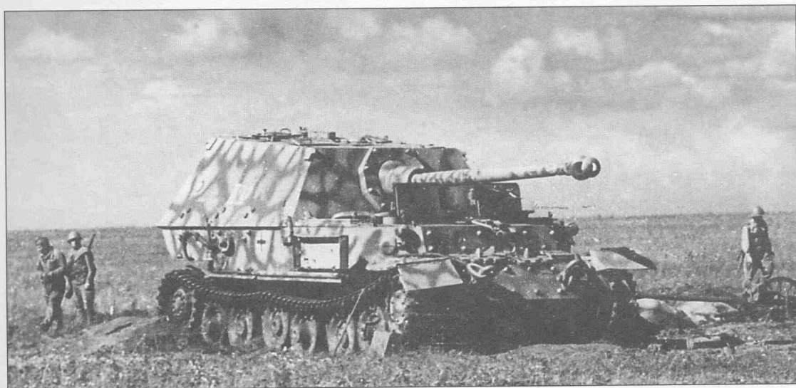
Штабной «Фердинанд» из 654-го батальона. Один из немногих, не имевший противоосколочного щитка на маске пушки. The Ferdinand SPG belonging to 654th battalion headquarters. One of the few vehicles which didn't have the gun mantlet protection plate.
