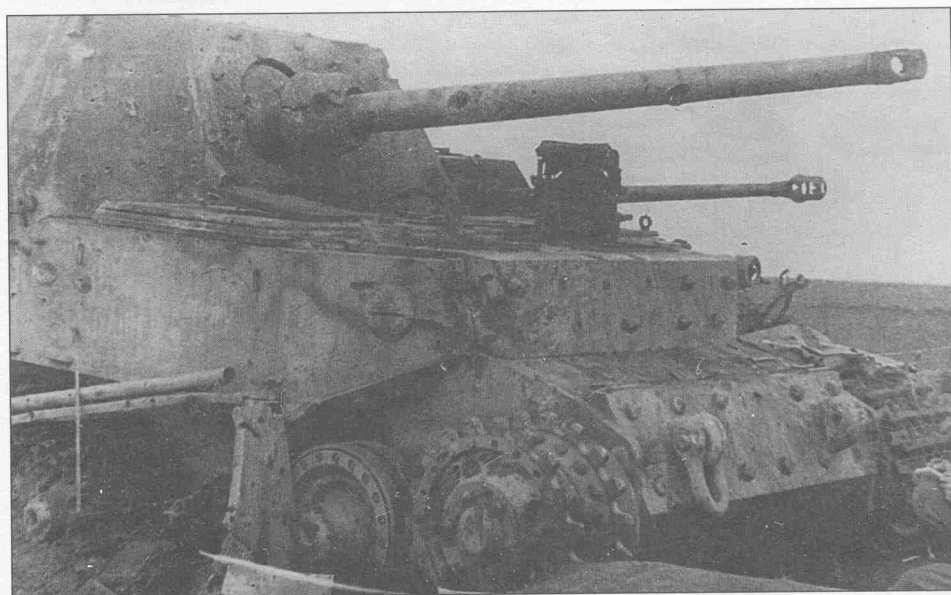
Два подорванных у пос. Горелое «Фердинанда» 654-го батальона. На верхней фотографии видна комиссия ГАБТУ, занятая осмотром подбитых машин. На нижней фотографии хорошо видно большое количество пробоин в стволе орудия. Таким образом бойцы ИПТАП стремились обезоружить танки и САУ, потерявшие ход. В стволе данной машины имеется 8 пробоин калибра от 14.5 мм до 45 мм. Но в среднем (считая пробоины в стволах танков) это количество обычно не превышало 3-х. Two damaged vehicles of 654th battalion near Goreloye village. Not the holes in the gun barrels – Soviet artillerymen always «de-armed» stopped Ferdinands.
