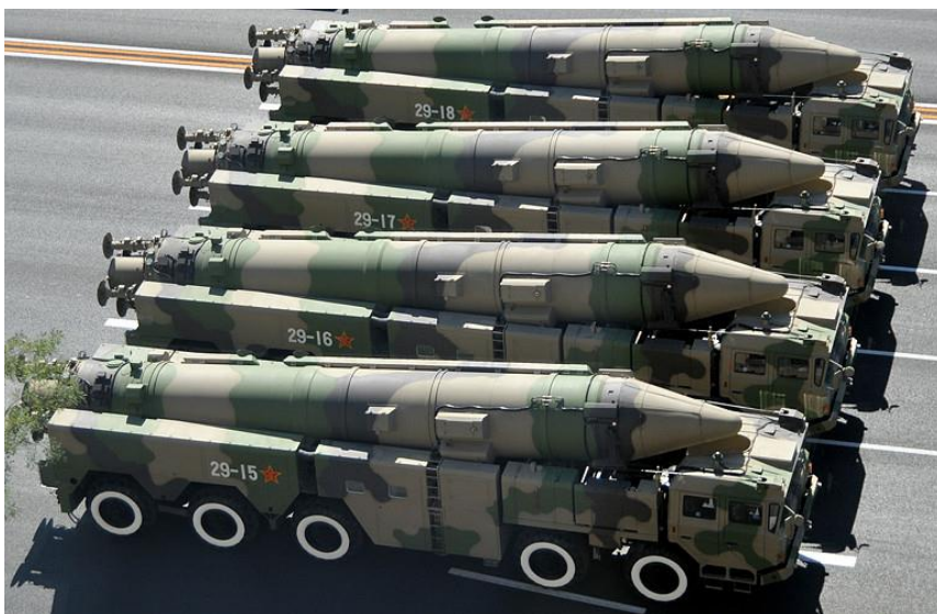
ФОТО 17: Ракетные комплексы DF-21C на шасси WS-2500 на параде: www.ausairpower.net .
